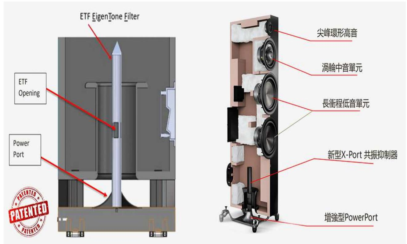
Polk Audio 專利的 X-Port 技術，中空的吸音管經過特別設計，可以吸收特定頻率諧震，配合原有的 PowerPort，可以讓低音輸出更加乾淨，同時提升低頻分析力。
